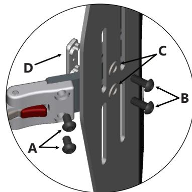
1. Fixez le support à 135° au côté à l'aide des vis à tête ronde M6 x 1,0 x 10 mm fournies (A).
