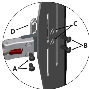
1. Fissare la staffa a 135° al lato utilizzando le viti a testa tonda M6 x 1,0 x 10 mm incluse (A).
