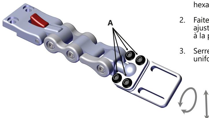
1. Desserrez les vis à tête ronde M6 x 1,0 x 12 mm (A) avec une clé hexagonale 4mm.
