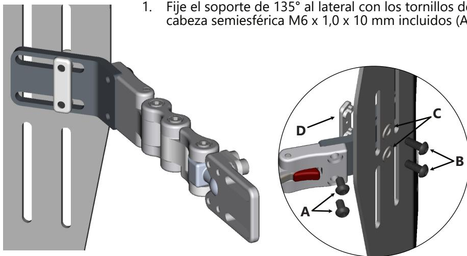
2. Coloque el lateral en el interior de la carcasa trasera y coloque la tuerca del riel lateral (D) en las ranuras del soporte de 135°.
