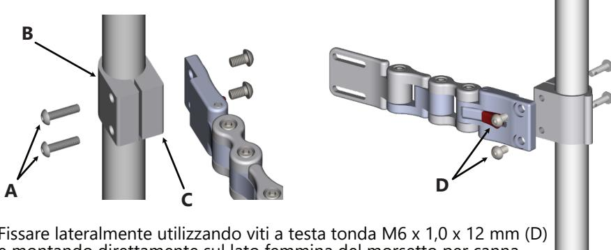
2. Fissare lateralmente utilizzando viti a testa tonda M6 x 1,0 x 12 mm (D) e montando direttamente sul lato femmina del morsetto per canna. Serrare con una chiave esagonale 4mm.
