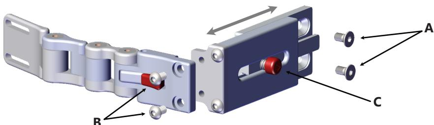
2. Utilisez les vis à tête ronde M6 x 1,0 x 12 mm (B) pour monter directement le latéral sur le support toutes saisons. Serrez avec une clé hexagonale 4mm.
