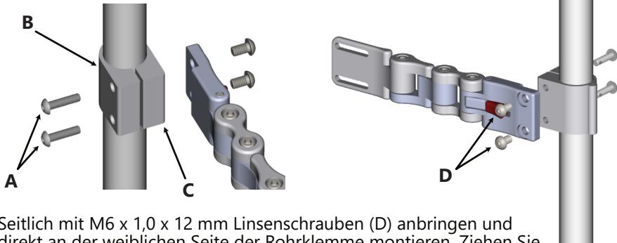
2. Seitlich mit M6 x 1,0 x 12 mm Linsenschrauben (D) anbringen und direkt an der weiblichen Seite der Rohrklemme montieren. Ziehen Sie mit einem 4mm Sechskantschlüssel fest.
