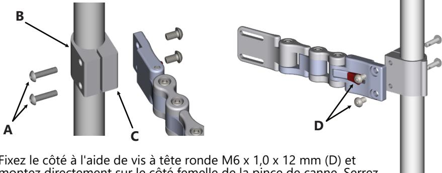
2. Fixez le côté à l'aide de vis à tête ronde M6 x 1,0 x 12 mm (D) et montez directement sur le côté femelle de la pince de canne. Serrez avec une clé hexagonale 4mm.
