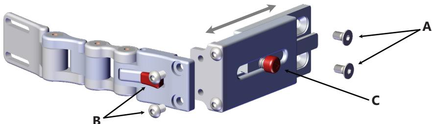
2. Verwenden Sie die Halbrundkopfschrauben M6 x 1,0 x 12 mm (B), um das Seitenteil direkt an der Ganzjahreshalterung zu montieren. Mit einem 4mm Sechskantschlüssel festziehen.
