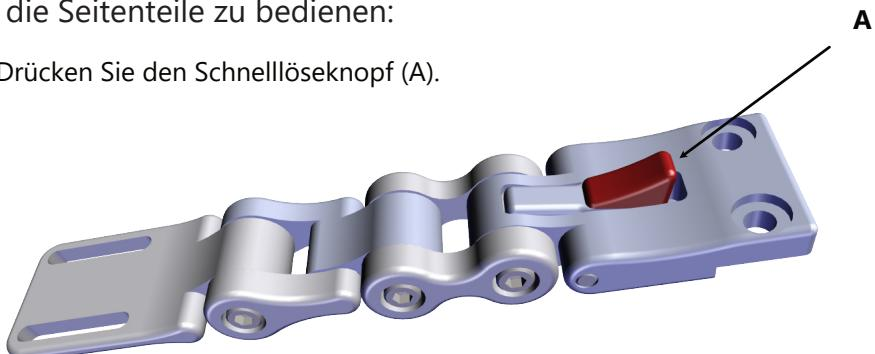
2. Das Seitenteil schwingt frei um 134° auf beiden Seiten der ursprünglichen verriegelten Position.
