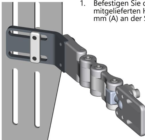
1. Befestigen Sie die 135°-Halterung mit den mitgelieferten Halbrundkopschrauben M6 x 1,0 x 10 mm (A) an der Seitenwand.
