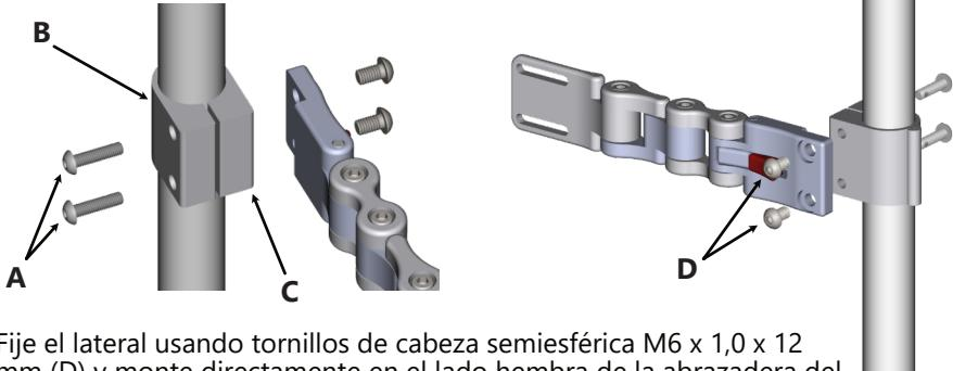
2. Fije el lateral usando tornillos de cabeza semiesférica M6 x 1,0 x 12 mm (D) y monte directamente en el lado hembra de la abrazadera del bastón. Apriete con una llave hexagonal 4mm.
