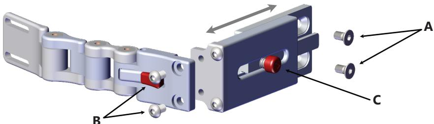
2. Utilice los tornillos de cabeza semiesférica M6 x 1,0 x 12 mm (B) para montar directamente el lateral en el soporte para todas las estaciones. Apriete con una llave hexagonal 4mm.
