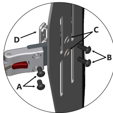
2. Positionieren Sie das Seitenteil an der Innenseite der Rückenschale und platzieren Sie die seitliche Schienenmutter (D) in den Schlitten an der 135°-Halterung.
