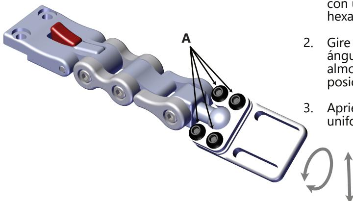
1. Afloje los tornillos de cabeza semiesférica M6 x 1,0 x 12 mm (A) con una llave hexagonal 4mm.
