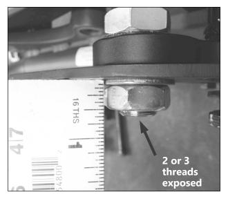
**Step 6:** Tighten the OEM bolt.
